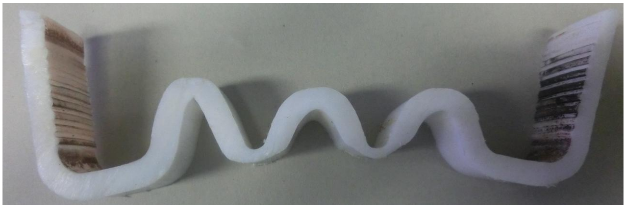
Abb. 2: Schlechte Ausformung des PTFE-Balgs mit extremer Wanddickenschwankung
